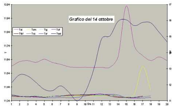
Fig. 5 - Andamento delle Temperature nella giornata di misura del disturbo termico procurato da una visita di sei persone (Text = T esterna; Tst = T Sala Topografica; Tsm = T Sala Merloni; Tig = T Inizio Gaggia; Tsf = T Sala Franosa; Tfsf = T Fine Sala Franosa; Tvc = T Vecchio Campo; Tsr = T Sala Rinaldi).
