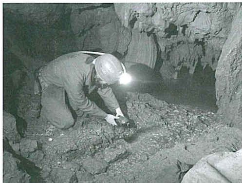
Iniezione del colorante al sifone terminale
