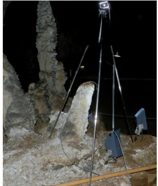
*Fase di misurazione delle temperature sul faro a 2 LED 3W (foto Morena Bonaccorsi)*
